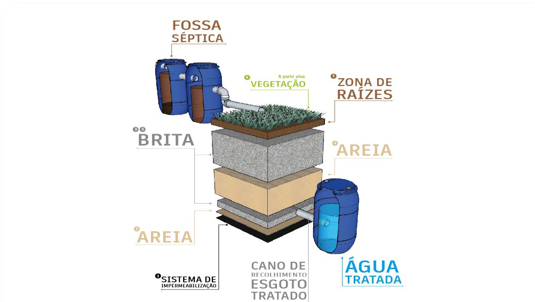
FIGURA 6 – Sistema de Tratamento de Esgoto por Zona de Raízes
